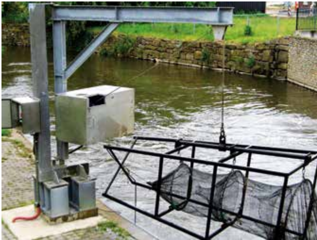
Große Reuse am Grundablass
